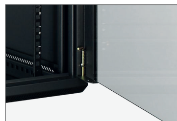
La goupille à ressort en L permet une installation rapide de la porte avant, et offre la possibilité de changer le sens d'ouverture rapidement.
